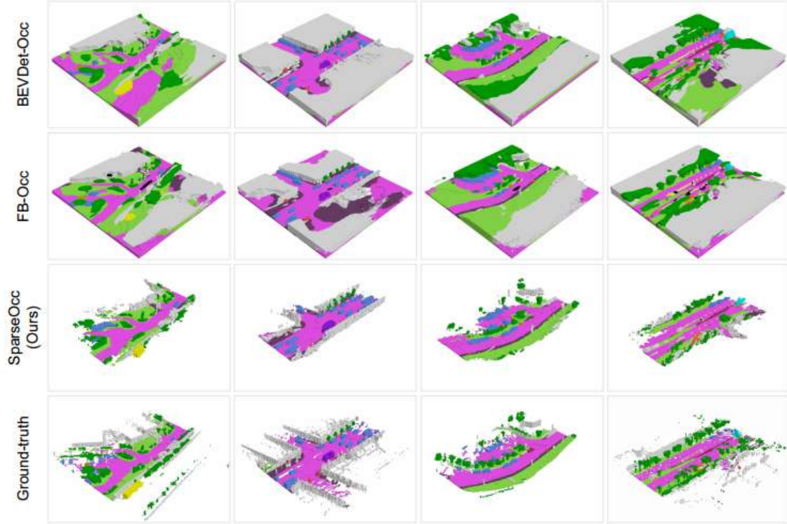
图 7: 语义占用预测的可视化比较。尽管丢弃了超过 90% 的体素, 我们的 SparseOcc 有效地模拟了场景的几何形状, 并捕获了细粒度的细节 (例如, 底部一行的黄色标记的交通锥)。
